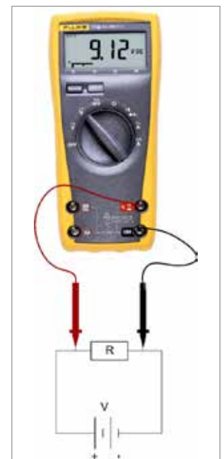
Fig. 2 Matja e tensionit me multimetër
