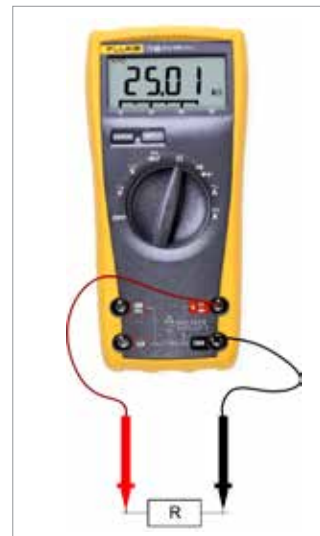
Fig. 3 Matja e rezistencës me multimetër
