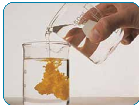
Fig. 2.5 Formimi i precipitatit gjatë reaksionit mes tretësirës së sulfurës së natriumit dhe nitratit të kadmiumit.
