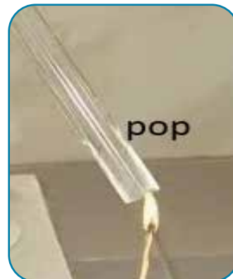
Fig. 3.7 Vërtetimi i pranisë së hidrogjenit
