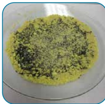
Fig. 1.25 Ndarja me magnet e hekurit nga sulfuri
