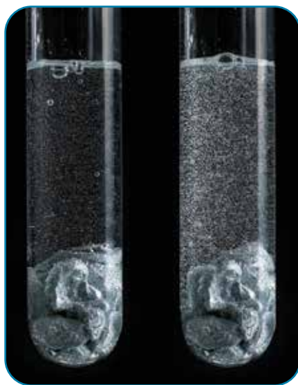
Fig. 2.2 Reaksioni mes acidit klorhidrik dhe zinkut
