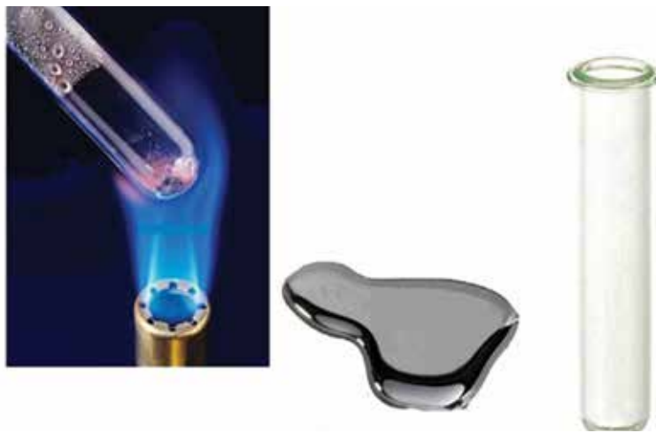
Fig.2.11 Zbërthimi i oksidit të merkurit në merkur dhe oksigjen elementar
