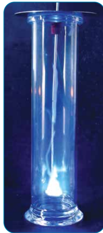
Fig. 2.10 Djegia e sulfurit në prani të oksigjenit formon dioksidin e sulfurit.
