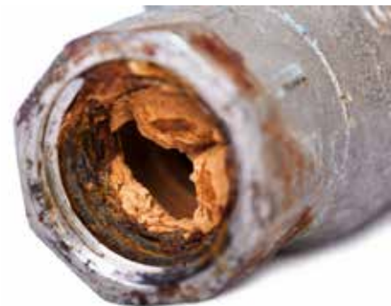
Fig. 3.4 Depozitimi i kripërave të kalciumit dhe magnezit brenda tubit të ujit
