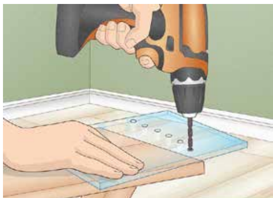
Fig. 2 Shpimi i plastikës me trapan elektrik
